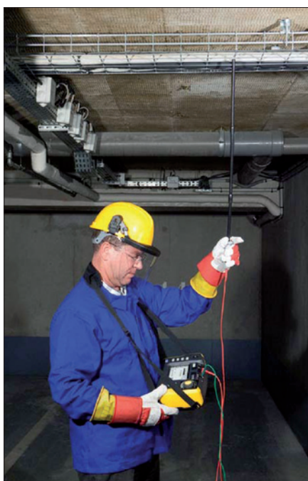
Obr. 1. C.A 6116 při měření impedance smyčky
