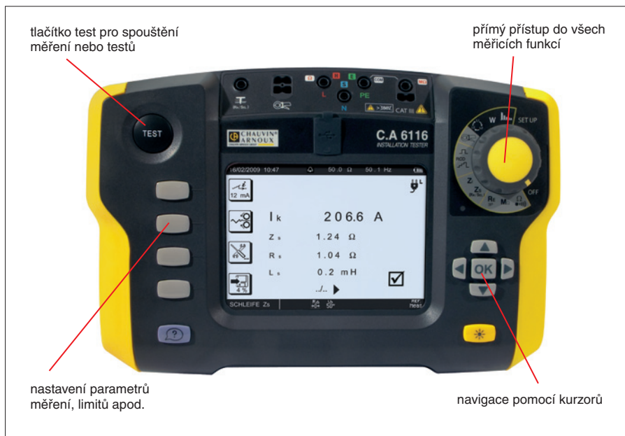
Obr. 1. C.A 6116 při měření impedance smyčky
