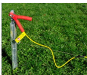
Připojení zemního pólu zkoušečky pomocí zabudovaných kleští. Zkoušečka disponuje vnitřním testem korektního připojení k zemnímu potenciálu.
