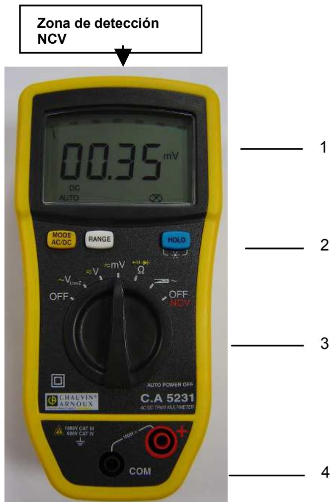
*Figura 1 : el multímetro C.A 5231*
