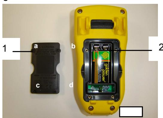
*Abb. 6 : Batteriefach*
