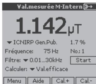
Lorsque l'on passe en mode de mesure pondérée (ou en normée), et que l'on sélectionne le « calibre manuel », c'est à dire en décochant le « Calibre Auto », il est possible de changer le calibre de « Cal 1 », le plus sensible vers le calibre le moins sensible, « Cal 5 ou 6 » suivant les cas.
