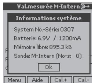
N° de série de l'instrument et identification de la sonde en cours d'utilisation, (N° de série et type), ainsi que capacité mémoire libre et 'autonomie restante de la batterie. Dans le cas de l'utilisation d'une sonde EF400, l'autonomie de sa batterie interne est donnée dans cette rubrique.
