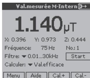
Les composantes en X, Y et Z de la valeur principale affichée correspondent au mode de calcul sélectionné (Ex.: Val.efficace) et dépendent de la plage de fréquence choisie.
