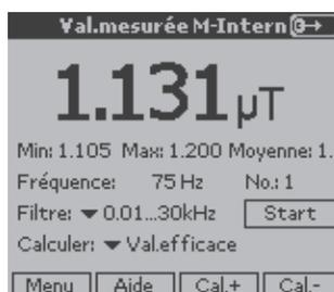
Les valeurs Min, Max et Moyenne de la valeur principale affichée correspondent au mode de calcul sélectionné (Ex.: Val.efficace) et dépendent de la plage de fréquence choisie (Ex.: 0,01 ... 30kHz).
