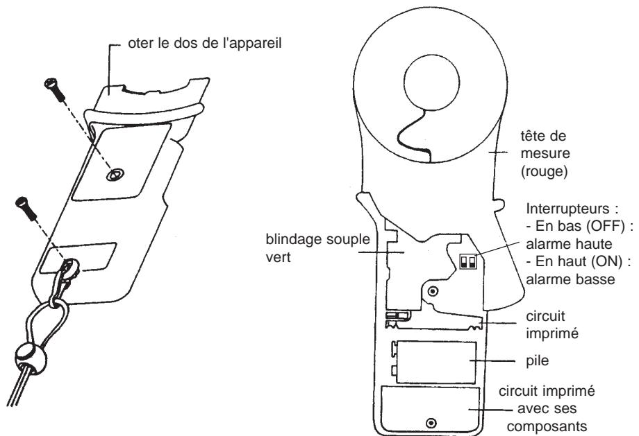
Selon le type d'alarme sélectionné, le franchissement du seuil d'alarme sera signalé par l'apparition du symbole **AL** ou **AL** et du bip sonore continu à haute ou basse fréquence.
