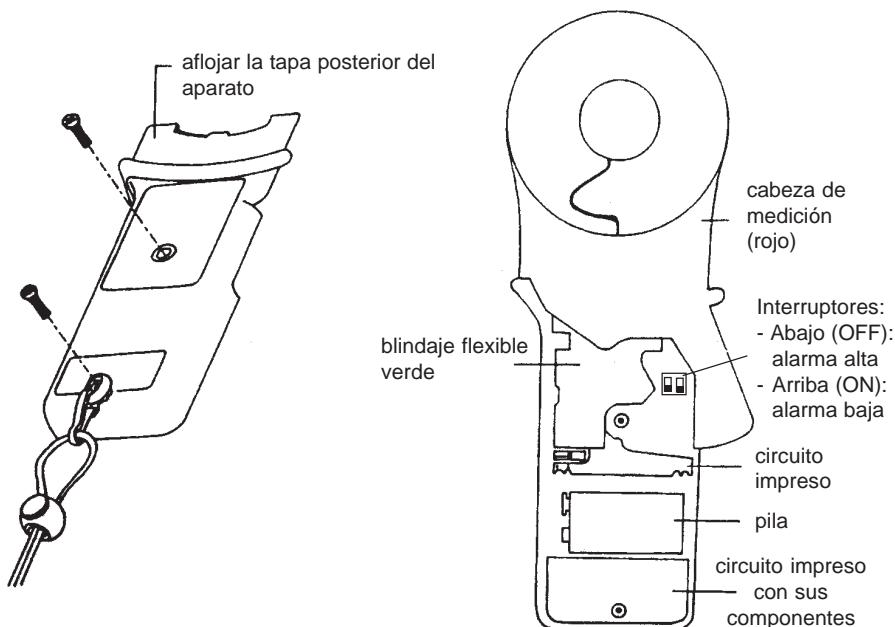
Según el tipo de alarma seleccionada, al franquearse el umbral de alarma aparecerá la señal o y un bip sonoro continuo a alta o a baja frecuencia. Una nueva pulsación en el botón **AL** permite salir de la función de alarma (desaparece el símbolo **AL**). Si se para el aparato sin salir del modo alarma, se conservará esta configuración. Por consiguiente, el aparato reactivará automáticamente la función de alarma al volverse a poner en marcha.
