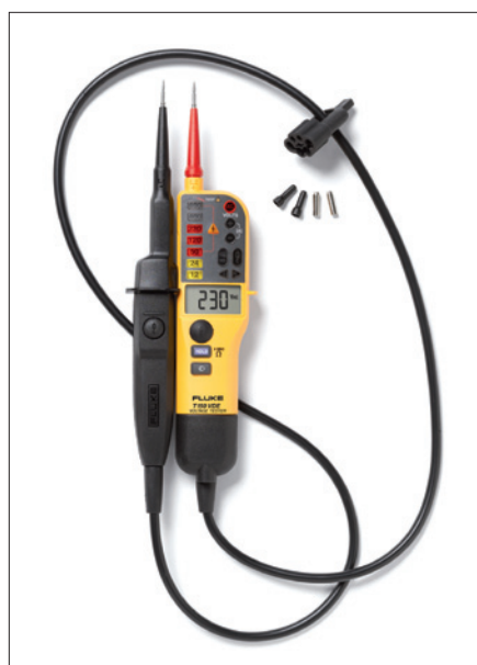
Obr. 1. Fluke T150; tlačítka na obou částech zkoušečky umožňují zatížit zkoušený obvod, a tím vyloučit indukovaná napětí
