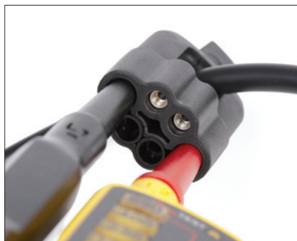
Obr. 4. Pohled do krytu hrotů s kapslí na úschovu 4mm adaptérů a krytek hrotů
