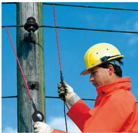
Obr. 1. Měření se zkušební přístrojem vybavenou nástavcem
