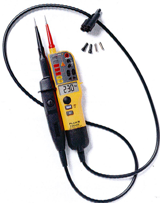
Obr. 1 Fluke T150, Tlačítka na obou částech zkoušečky umožňují zatížení zkoušeného obvodu a tím eliminaci indukovaných napětí
