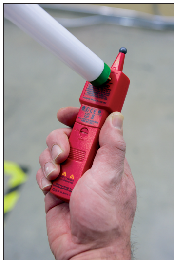
Obr. 5. Testování pinů zářivek – měření propojení
