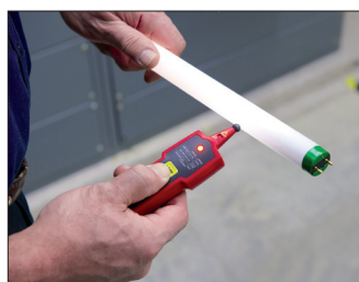
Obr. 3. Kontrola přítomnosti plynu
