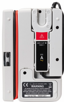
Obr. 2 Proudové kleště jsou v umístění v přepravní poloze na zadní straně přístroje
