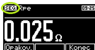
Obrázek 42: Aktivace automatického pracovního postupu
