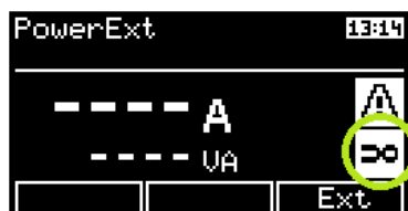
Obrázek 47: Aktivace vstupu pro externí měřicí zařízení
