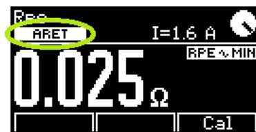
Obrázek 39: Aretace tlačítka [TEST]
