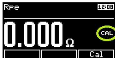
Obrázek 45: Kompenzace odporu měřicích šňůr
