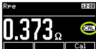
Obrázek 46: Chyba kompenzace odporu měřicích šňůr
