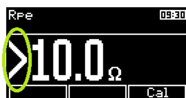
Obrázek 43: Naměřená hodnota je mimo rozsah (max)
