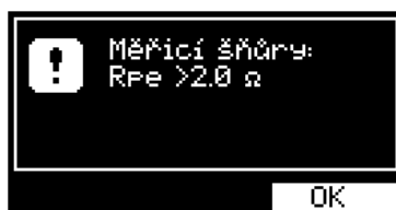
Obrázek 34: Varovné hlášení: Měřicí šňůry: Rpe >2.0 Ω
