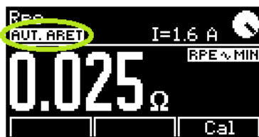
Obrázek 40: Automatická aretace tlačítka [TEST]
