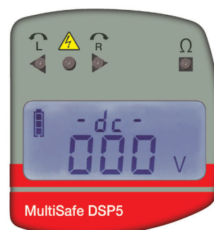
Barva podsvícení displeje se mění v závislosti na měřeném napětí
