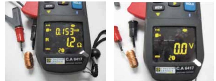
Obr. 4 a 5 Ukázky dalších možností zobrazení: Naměřená impedance a dotykové napětí
