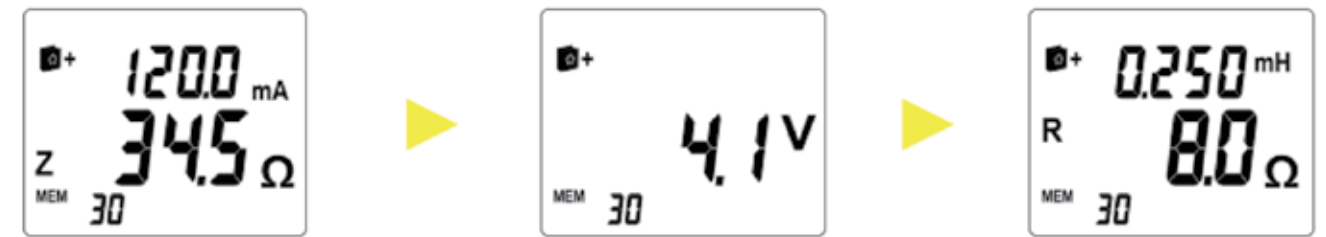
Obr. 6: Proud, impedance, dotykové napětí, odpor a indukčnost ve smyčce, zobrazení data a času měření. Obrazovky se volí opakovaným stisknutím kurzoru
