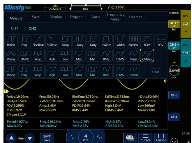
31 automatických měření. Různé automatické testy můžou mít odlišné požadavky. Vše je možné zobrazit na jedné straně.
