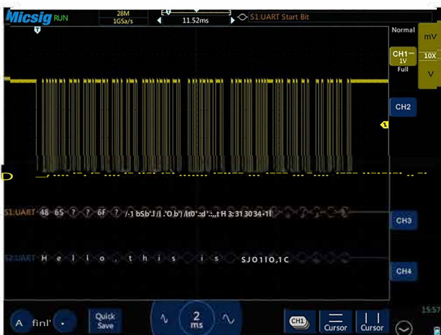
Dekódování a analýza běžných sériových sběrnic (I2C, SPI, RS232/UART, CAN, LIN) a sběrnic v letectví a obraně (MIL-STD 1553, ARINC 429). Zobrazení v textovém i grafickém formátu.
