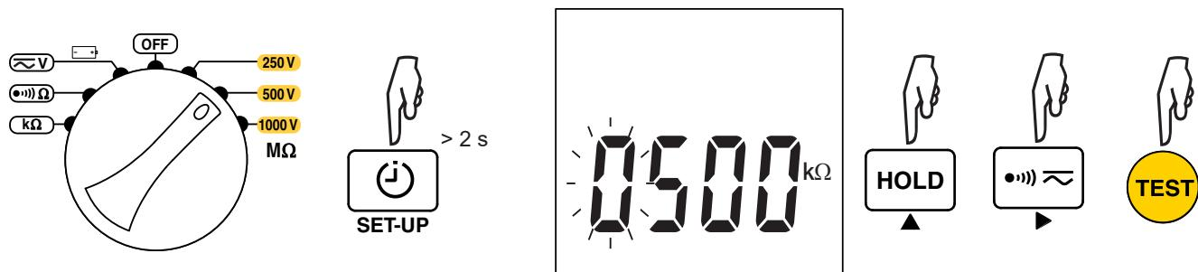
Pomocí tlačítka ▲ nastavte číslici a tlačítkem ▶ přejděte na následující číslici. Po nastavení všech 4 číslic zvolte jednotku. Potvrďte nastavení stisknutím tlačítka **TEST**.
