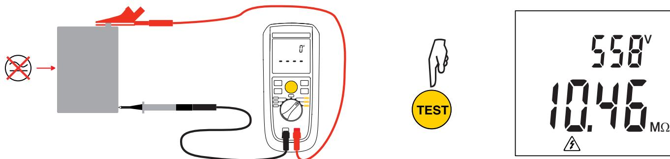
Stiskněte tlačítko **TEST** a ponechejte je stisknuté, dokud se hodnota neustálí. Symbol indikuje, že přístroj vytváří nebezpečné napětí.
