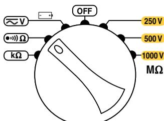
Nastavte přepínač do polohy  $\bullet\bullet\bullet \Omega$ .
