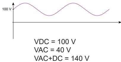
Je-li napětí smíšené (kombinace střídavého a stejnosměrného napětí), jak uvádí příklad naproti - zvlněné stejnosměrné napětí, měření napětí AC+DC poskytuje správnou hodnotu, zatímco měření střídavého napětí (AC) ne.
