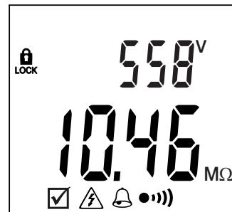
Limity alarmu jsou programovatelné (viz § 3.9). Pro každé testovací napětí se nastavuje jeden limit.
