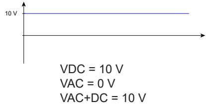
Je-li napětí pouze stejnosměrné (DC), naměřená hodnota střídavého napětí (AC) je nulová.
