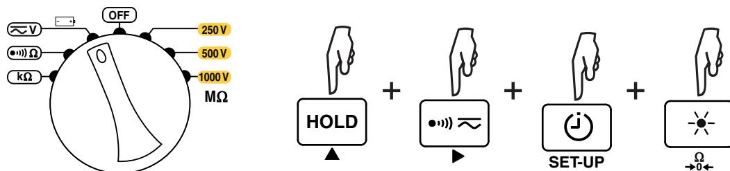
V každé fázi stiskněte tlačítko **TEST**. Přístroj provede nastavení a zobrazí potvrzení (**PASS** (úspěch) nebo **FAIL** (neúspěch)). Stiskněte tlačítko **►** pro přechod do následující fáze nebo tlačítko **▲** pro návrat do předchozí fáze.
