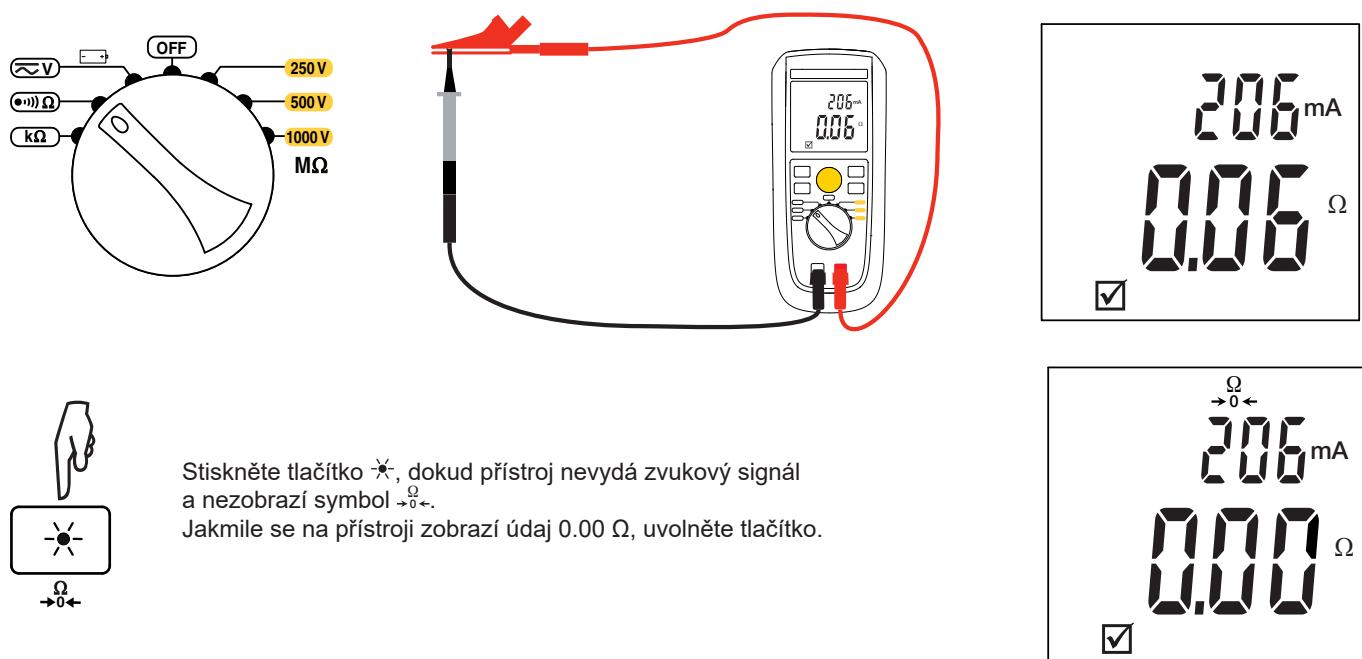
Kompenzace kabelů se používá také při měření odporu.
