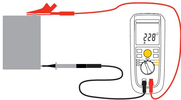
Na přístroji se zobrazí napětí AC+DC. Je-li přítomno napětí > 30 V, zobrazí se symbol , který upozorňuje uživatele na přítomnost nebezpečného napětí na svorkách.
