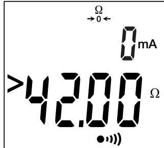
Je-li na displeji údaj **> 42.00 Ω**, došlo ke spálení pojistky a je nutné ji vyměnit.
