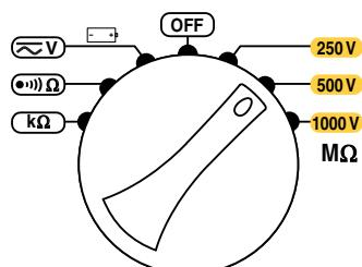
Nastavte přepínač do jedné z poloh **MΩ**.
