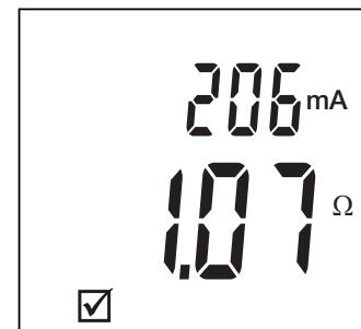
Abyste se ujistili, že není přítomno napětí, provedte před měřením propojení měření napětí.
