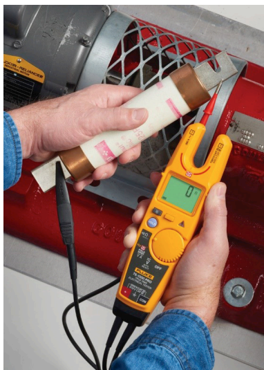
Obr. 3 kontrole propojení pomocí funkce „Visual Continuity“
