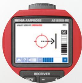
Velký barevný displej vás provede ve směru a orientaci vodiče pod napětím.
