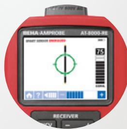
Snímač Smart Sensor™ signalizuje, že je nad místem napájeného vodiče. Displej zobrazuje přesný směr a orientaci vodičů.
