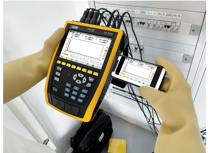
Analyzátor siete C.A 8345 umožňuje sledovať údaje na mobilnom telefóne v reálnom čase.
