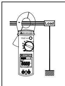
**Nota:** Per ragioni di sicurezza, disinserire i cordoni di misura della pinza prima d'effettuare l'operazione. La misura è ottimale con il conduttore centrato in mezzo alle ganasce
