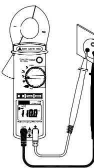
Drehschalter auf  $V\sim$  für AC-Spannungen bzw. auf  $V=$  für DC-Spannungen stellen.
