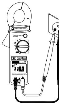
Positionner le commutateur sur V~ pour une mesure de tension alternative ou sur V= pour une mesure de tension continue.
